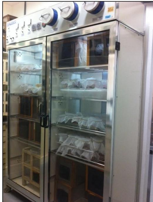
Figura 16. Estante ventilada com temperatura regulada em  $27 \pm 1^\circ\text{C}$ ,  $60 \pm 10\%$  URA e 12 de fototase (Acervo do pessoal).
