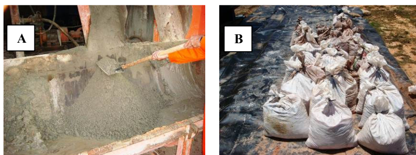
Figura 1.A - Cascalho de perfuração na calha de saída do material e B - acondicionamento das amostras.
