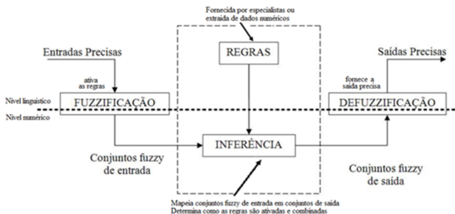
Figura 5. Sistema de inferência fuzzy . Fonte: adaptado de Tanscheit (2003)
