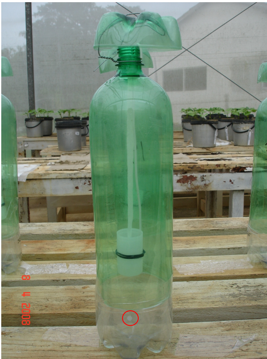
Figura 24. Detalhe do acoplamento da câmara coletora de amônia sobre base de garrafa PET e do rífcio destinado à entrada da agulha da seringa (cículo vermelho).
