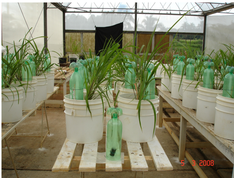
Figura 23. Câmaras coletoras de amônia ( \text{NH}_3 ) instaladas no experimento de capim-citronela.
